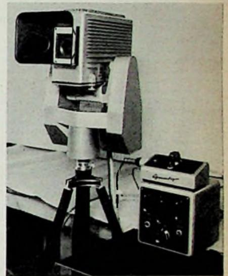
Bild 9. Grundig-Fernauge mit Schwenkkopf und Geräten für Fernbedienung aller Kamerafunktionen
