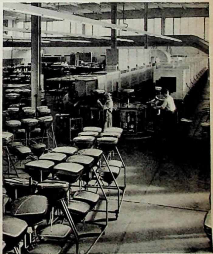
Bild 3. Blick auf die Ovalbahn der Pumpeneinheiten für Bildröhren. Jeder Röhre ist ein als Wagen konstruierter Pumpstand zugeordnet. Sie durchlaufen (im Bild rechts) einen Tunnelofen mit verschiedenen Heizzonen und hochfrequenten Glührichtungen, um das erforderliche Vakuum zu erzielen
